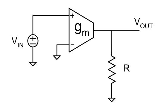
$$V_{_{OUT}}=g_{_{\rm m}}R\bullet V_{_{\rm IN}}$$
